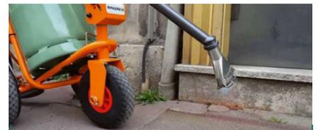
Mit dem Ripagreen Unkrautvernichter lassen sich mit einer Heissluftpistole einfach und effizient Unkräuter behandeln.
